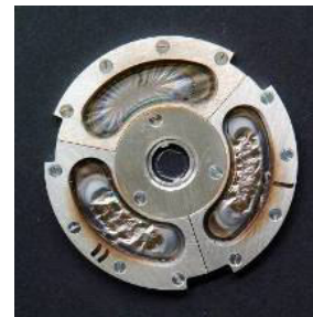
tarcza używana w projekcie TASCA Transactinide Separator and Chemistry Apparatus
